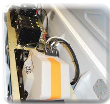
LiteMapper junto a DigiCAM, DigiTHERM y hiperspectral sensor AisaFENIX
