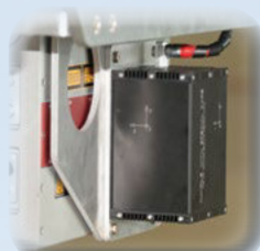
IMU de tipo FOG o MEMS para georreferenciación directa con AEROcontrol
