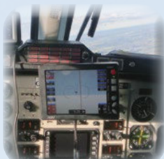
Pantallas de piloto y operador del sistema de guía de vuelo CCNS-5
